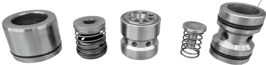
CONJUNTO DE VÁLVULAS
